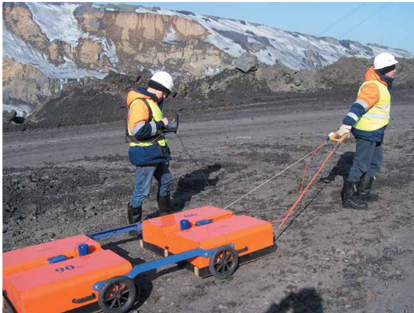
Георадарное обследование карьерной автодороги на предмет склонности к провалам и оползням, наличия под дорогой пустот
