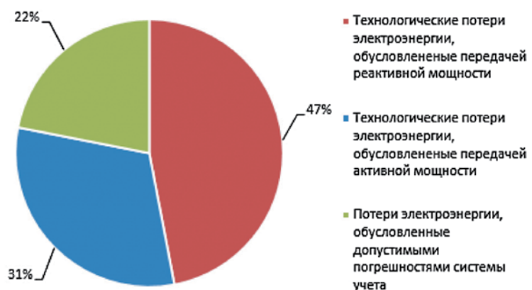
Рис. 1. Обобщенная структура технологических потерь электроэнергии в распределительных сетях электросетевых компаний Источник: Статья Р. Беляевского и А. Герасименко
